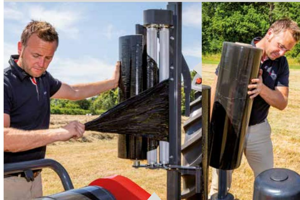
Obsluha může snadno nastavit požadovaný počet vrstev fólie podle plodiny a podmínek. Předpínací zařízení je určeno pro role s šířkou 500 mm nebo 750 mm a lze je nastavit pro předpětí 55 % nebo 70 % pro pevnější zabalení a menší spotřebu fólie. Rychloupínací systém umožňuje snadnou a rychlou výměnu rolí. Díky úložnému místu lze přepravovat až 3 náhradní role fólie.
