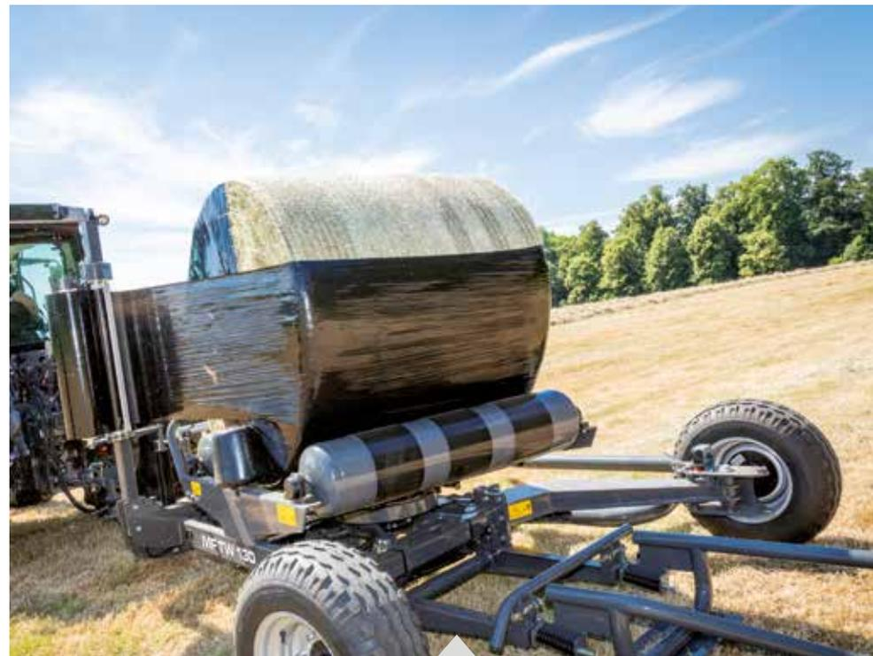
Vpravo umístěné opěrné transportní kolo na stroji MF TW 130 lze snadno otočit kolem středního čepu pro zvýšení celkové přepravní šířky z 2,30 m na 2,85 m, a tím se zvětší také celková stabilita baličky.
