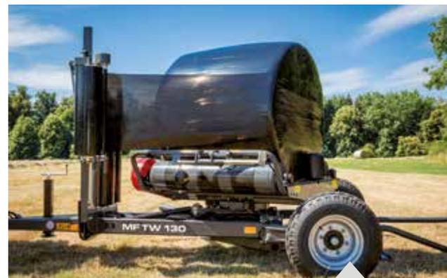
Správné překryvání fólie zaručuje poměr rychlosti otáčení balíku a otáčení balicího stolu. Vodítka na balicím stole zaručují, že balík zůstane pevně umístěn uprostřed stolu.
