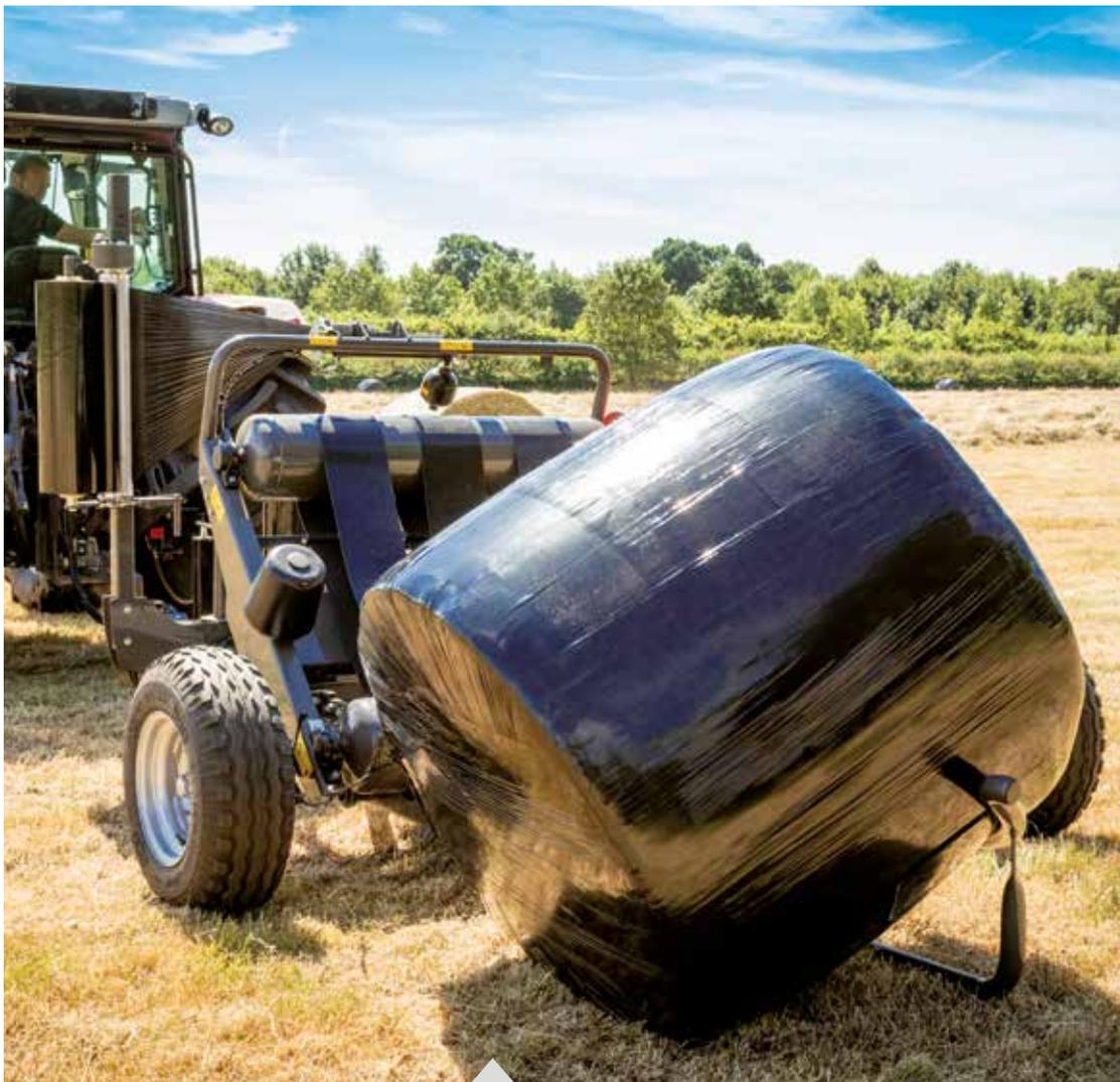
Vykládání balíků je velmi šetrné bez rizika poškození fólie zabaleného balíku nebo půdy, a to díky nízkému posazenému baličímu stolu, který se při vykládání balíků sklání nízkou nad povrchem půdy.
